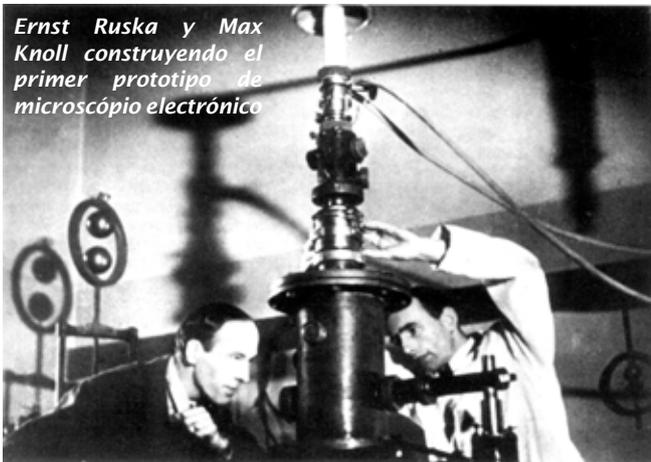
Ernst Ruska y Max Knoll construyendo el primer prototipo de microscopio electrónico
